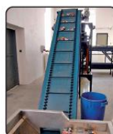
3. posuvný dopravník, kterým jsou baterie dopravovány na třídící síta, kde dochází podle jednotlivých průměrů k separaci knoflíkových baterií
