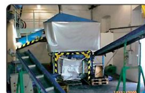
7. vibrační síto; odděluje se zde podsítný podíl z prvního třídění
