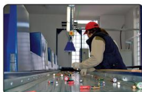
4. ruční dotřídění podle chemického druhu baterií
