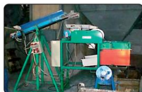
8. separátor oddělí zinkovou drť od plastu a papíru
