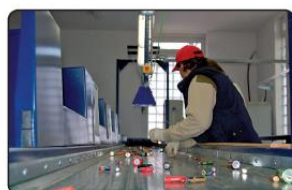
4. ruční dotřídění podle chemického druhu baterií
