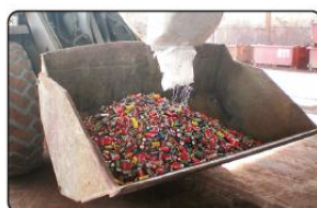
6. přeprava vytříděných baterií na recyklační linku
