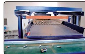
3. posuvný dopravník, kterým jsou baterie dopravovány na třídící síta, kde dochází podle jednotlivých průměrů k separaci knoflíkových baterií
