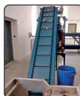
3. posuvný dopravník, kterým jsou baterie dopravovány na třídící síta, kde dochází podle jednotlivých průměrů k separaci knoflíkových baterií
