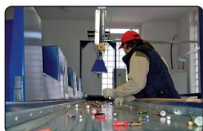
4. ruční dotřídění podle chemického druhu baterií
