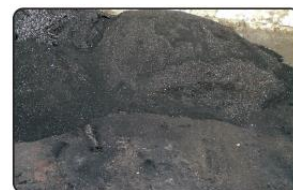
11. podsítný podíl tvořený 20% zinku a 30% manganu
