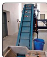
3. posuvný dopravník, kterým jsou baterie dopravovány na třídicí síta, kde dochází podle jednotlivých průměrů k separaci knoflíkových baterií
