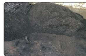
11. podsítný podíl tvořený 20% zinku a 30% manganu
