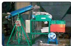
8. separátor oddělí zinkovou drť od plastu a papíru
