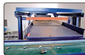
3. posuvný dopravník, kterým jsou baterie dopravovány na třídicí síta, kde dochází podle jednotlivých průměrů k separaci knoflíkových baterií
