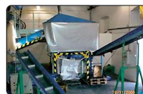
7. vibrační síto; odděluje se zde podsítný podíl z prvního třídění
